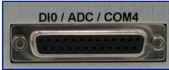
Enclosure TS-ENC550 DIO/ADC/COM4 Port
